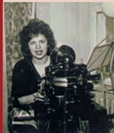
Praca przy maszynie adresopresowej Adrema, za pomocą której pracownik wybił metalowe płytki (klisze) do przekazów pieniężnych dla świadczeń emerytalno – rentowych. Na kliszach wytłaczano imię i nazwisko, adres świadczeniobiorcy oraz kwotę do wypłaty. Na zdjęciu Urszula Kujawińska. Zbiory ZUS Oddział w Legnicy
